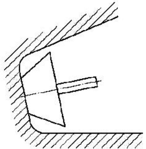
Рисунок 10 - Проверка соответствия оборудования требованиям к обеспечению предотвращения застреваний частей тела
