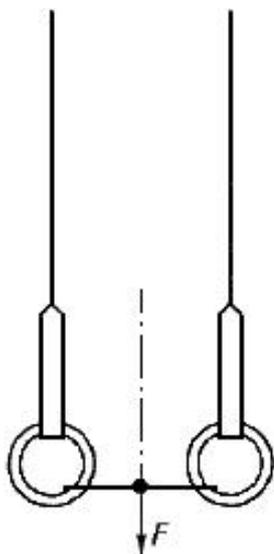
Рисунок 5 - Определение прочности закрепления гимнастических колец
